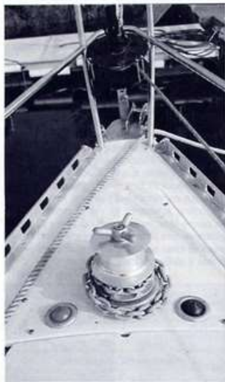
Nella foto sopra un'immagine del verricello elettrico salpa-ancora. Il materiale di costruzione, come per tutto il resto delle attrezzature di coperta, è di massima affidabilità, quindi dà garanzia di durata nel tempo.
