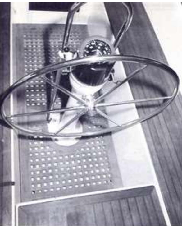
Una panoramica del pozzetto con la ruota del timone. Sarebbe stato preferibile, data la lunghezza dello scafo, adottare un timone a barra che avrebbe lasciato più libertà di movimento al timoniere.
