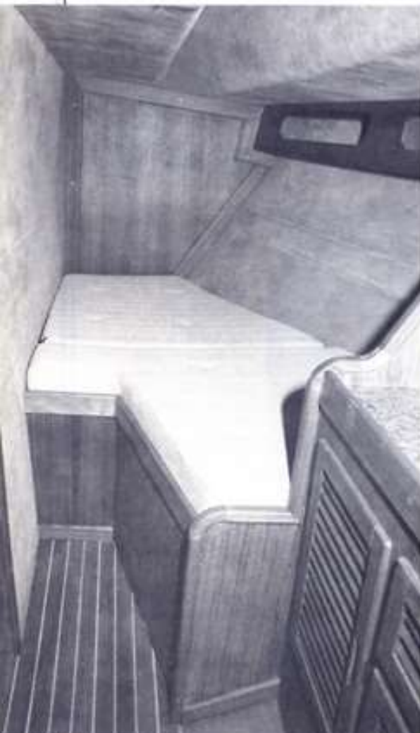
Nella foto sopra la cuccetta della cabina di poppa. Come si può notare è sufficientemente spaziosa. Pur dando accesso al vano motore è da questo isolata da un ottimo sistema fonoassorbente. Nell'Altura 1101 ripostigli, cassetiere e armadi sono in numero sufficiente, il che consente un ordinato e funzionale stivaggio dei materiali di bordo.
