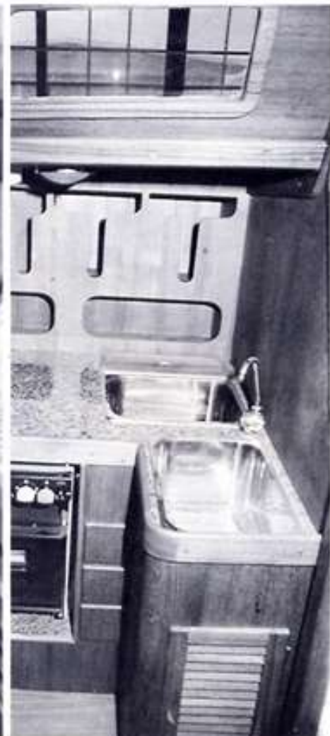
La cucina è funzionale e non mancherà di incontrare le simpatie del gentil sesso, per la sua disposizione. Come si conviene ad un'imbarcazione «marina», il piano di cottura (posto sotto il ripiano di marmo ribaltabile) è basculante ed è fornito di fermapentole, accessorio semplice ma indispensabile quando si vuole cucinare in navigazione.
