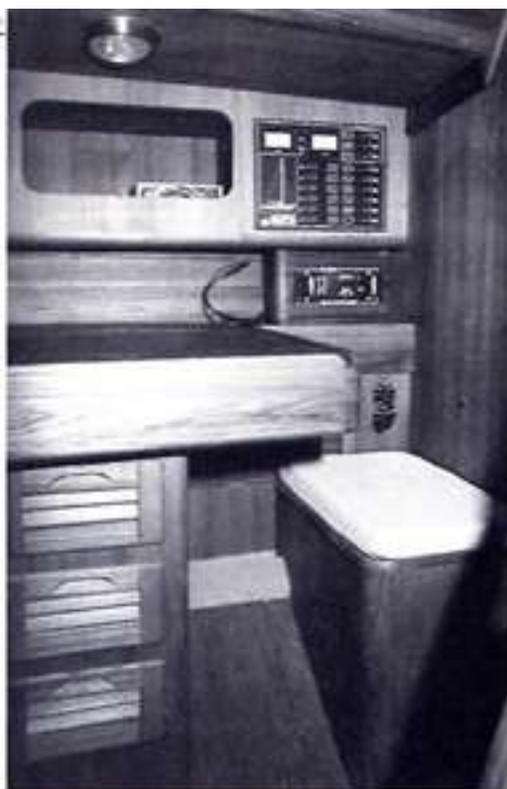
Il tavolo da carteggio è spazioso e comodo. Tutta la strumentazione necessaria alla navigazione, compreso il quadro elettrico, è a portata di mano del navigatore.
